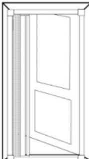
6. Снимите декоративные крышки с уголков. Зафиксируйте сетку саморезами через отверстия в углах. При больших размерах, рекомендуем дополнительно крепить профиль рамы.
