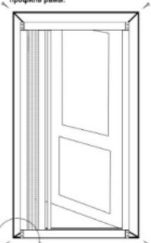
7. Закройте сетку. Если створка не равномерно заходит в раму. То со стороны где образовался зазор, при помощи плоской отвертки нужно повернуть стопорный винт, пока зазор не пропадет. Установите крышки обратно.
